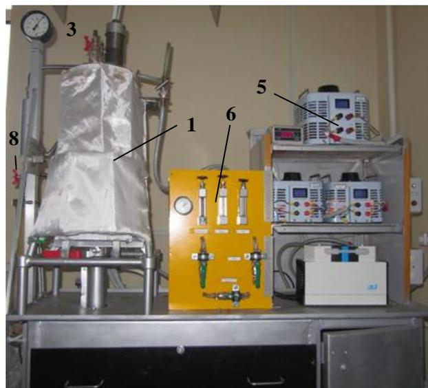
**Рисунок 1.** Опытная лабораторная установка получения углеводородных фракций из НСО
