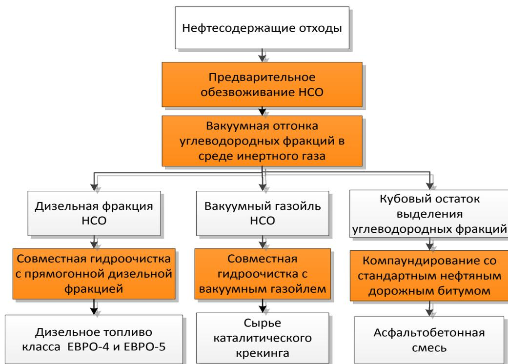
**Рисунок 10.** Блок-схема технологии получения углеводородных фракций на основе нефтесодержащих отходов
