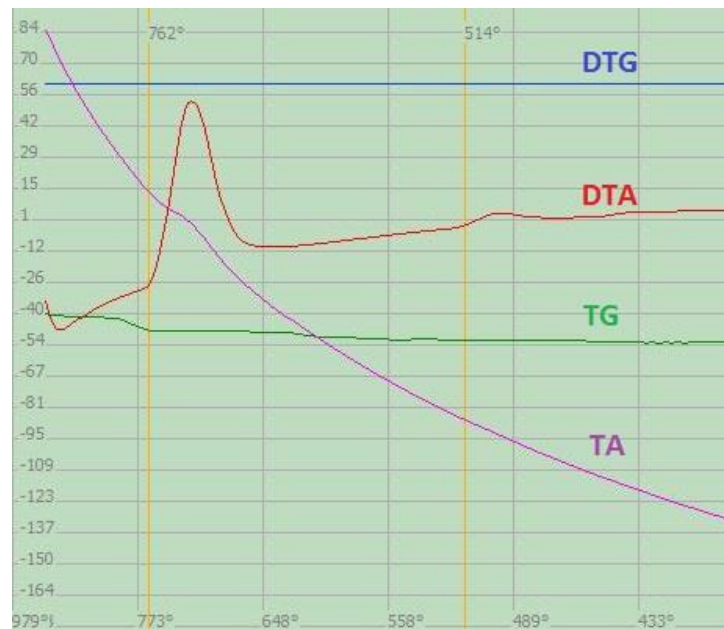
Рисунок 3.33 – Дериватограмма охлаждения состава 50 экв.% RbF + 50 экв.% Li 2 CrO 4
