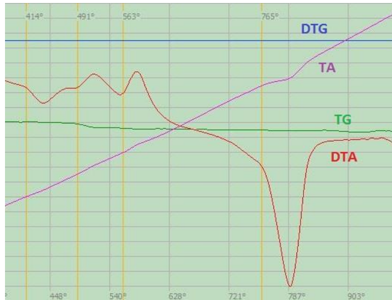
Рисунок 3.32 – Дериватограмма нагрева состава 50 экв.% RbF + 50 экв.% Li 2 CrO 4
