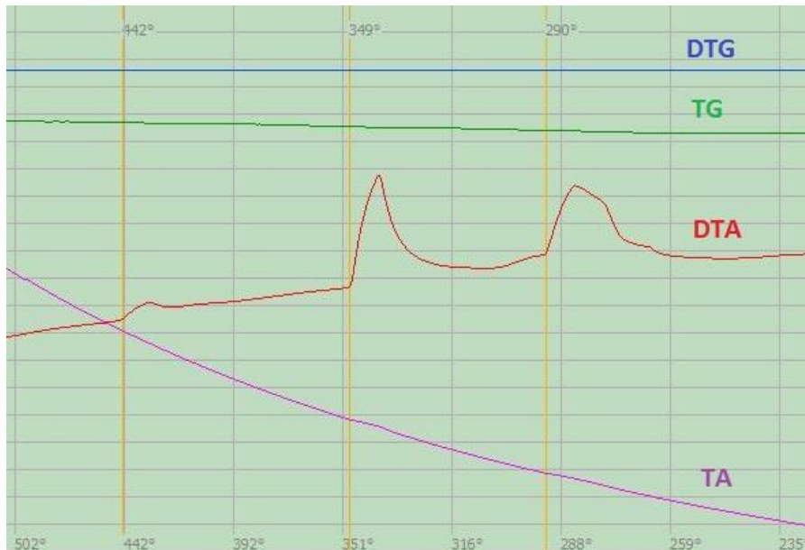
Рисунок 3.35 – Дериватограмма охлаждения состава 50 экв.% \text{RbCl} + 50 экв.% \text{Li}_2\text{CrO}_4
