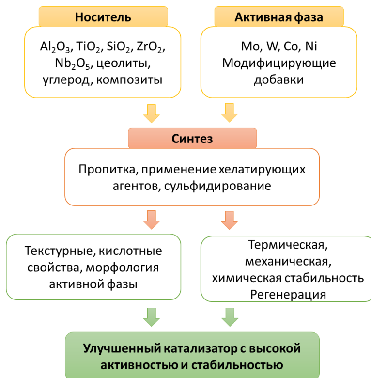
Рисунок 1.7 Схема синтеза высокоэффективного катализатора
