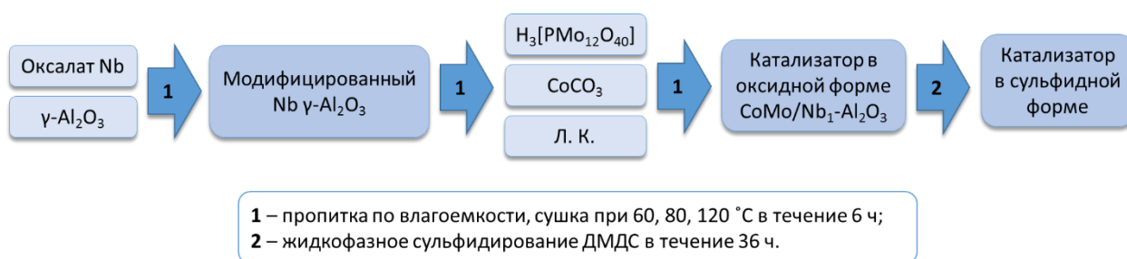
Рисунок 5.1 Схема синтеза Nb-модифицированных катализаторов гидроочистки дизельной фракции
