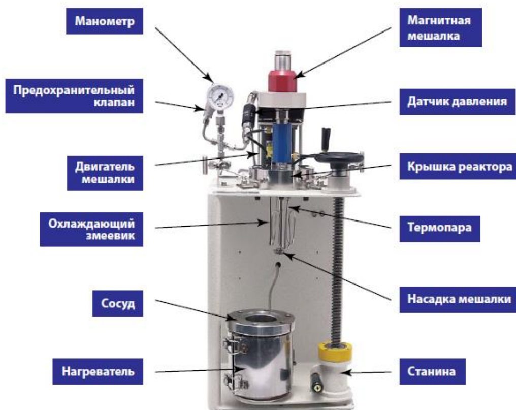
Рисунок 2.5 – Автоклав R-201 для исследования каталитической активности синтезированных образцов.
